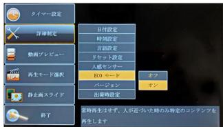
当社が開発した「ECO モード」は、人感センサー搭載サイネージに標準搭載している当社オリジナル機能です。「ECO モード」をオンにすると、センサーが人を検知した時のみ動画再生が始まり、通常は消灯状態になるため節電が可能です。「周囲に人がいないのに動画が流れている」という無駄な動画再生をなくします。
